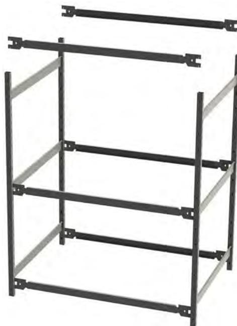
Pour installer les poutres, insérez une extrémité de la poutre au-delà des avis afin de laisser suffisamment d'espace pour que l'autre extrémité dégage le poteau et glisse facilement en place. Alignez les encoches une fois que les deux côtés sont bien insérés dans les fentes du poteau. Utilisez un maillet en caoutchouc pour fixer la poutre en place.
